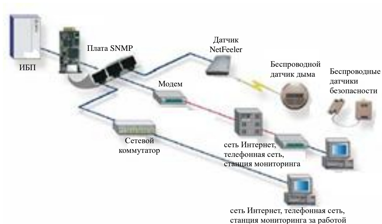
Стандартная топология сетевого управления ИБП
