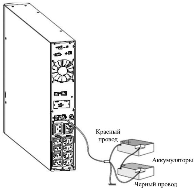
Рисунок 15 Подключение внешних батарей к ИБП с увеличенным временем работы
