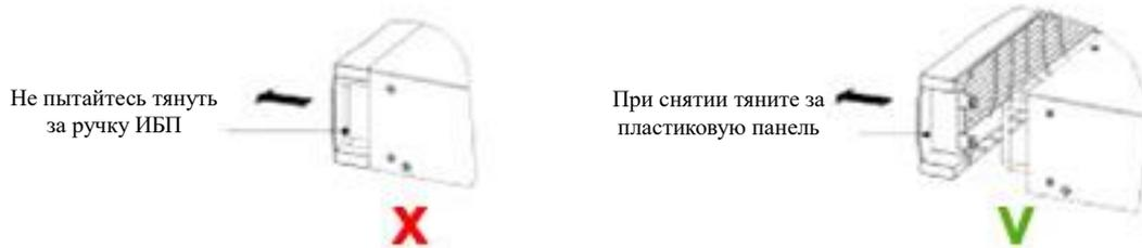
Рисунок 5 Снятие передней панели
