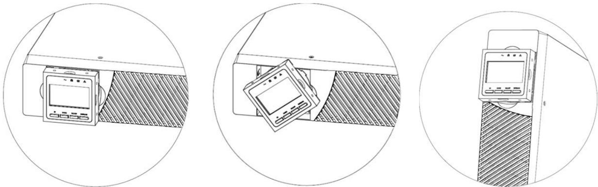
Рисунок 12 Поворот ЖК-дисплея ИБП при напольной установке
