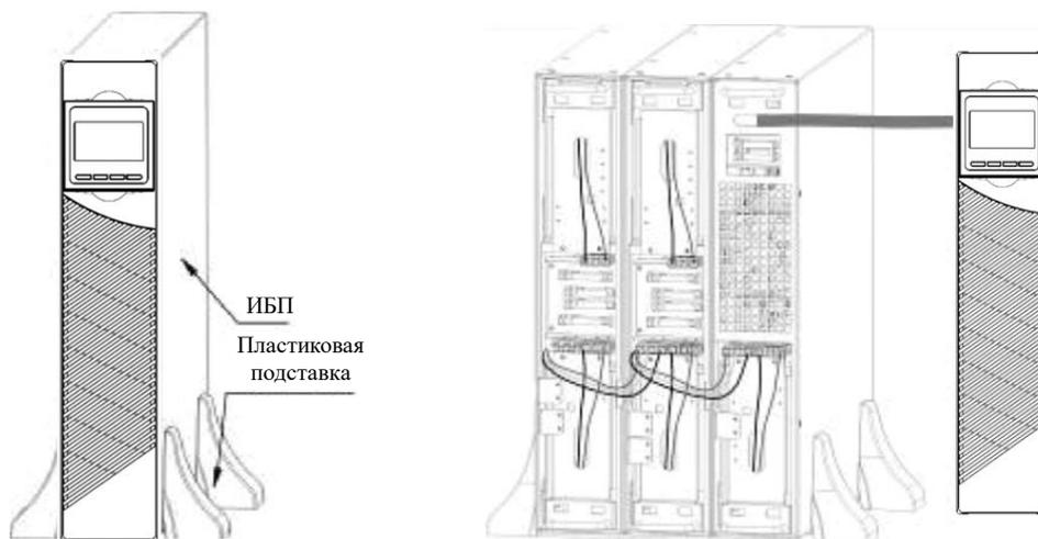
Рисунок 13 Напольная установка ИБП и батарейных блоков
